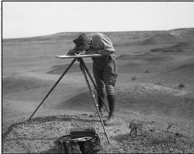
Рис. 04. На снимке слева – член экспедиции за проведением необходимых инструментальных измерений – секстант, мензальный стол. На снимке справа – в минуты отдыха Эндриус Р.Ч. кормит с рук птенцов беркута ( Aquila chrysaetos ). Северная Гоби, Внешняя Монголия, 1922-1931.
